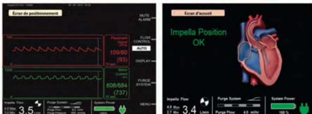
Figure 19 : Courbe de signal de positionnement du cathéter Impella™ (en rouge) et courbe du courant moteur (en vert).
