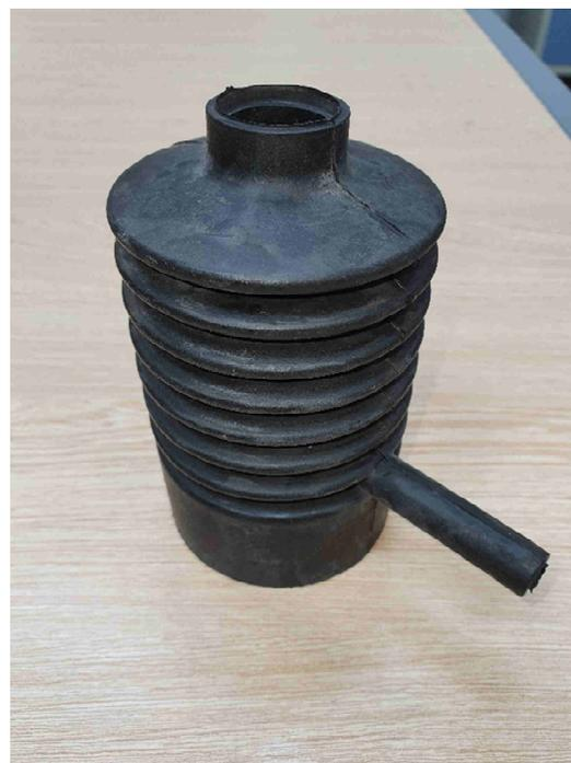
Figure 6 : Prototype de chambre à soufflet élastomère réalisée
