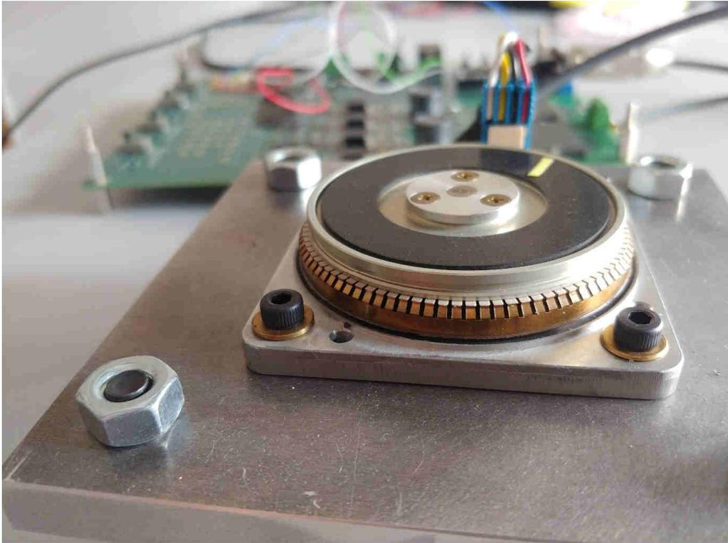
Figure 21 : Prototype du piézomoteur développé
